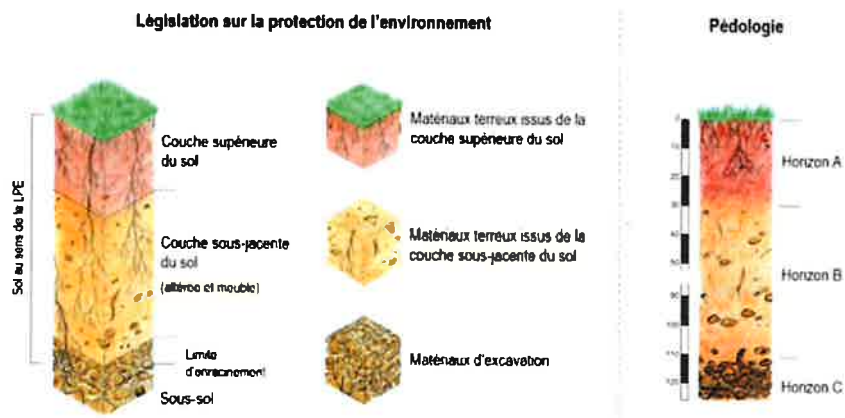
Figure 2 : Définitions du sol (source : Gestion respectueuse des sols lors de travaux de génie civil , OFEV 2022)
